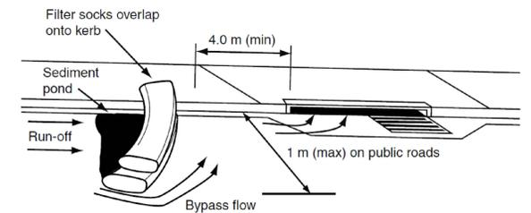
**ON-GRADE KERB INLET SEDIMENT TRAP**
